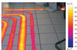
Die Firma Zink hat in eine Wärmebildkamera mit hoher Auflösung und verschiedenen Objektiven investiert. Dadurch ist eine unkomplizierte Ortung von Leitungswasserschäden und Rohrleitungen, wie z.B. Fußbodenheizungsrohren, möglich. Nun kann eine weitere Dienstleistung für die Kunden erbracht werden. Ziel der Investition war es auch, die Kompetenz in Sachen Heizung und Sanitär zu erweitern.
