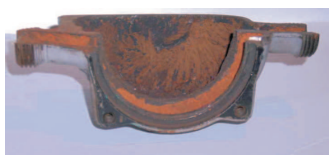
Ausfall einer Heizungspumpe aufgrund Steinbildung
